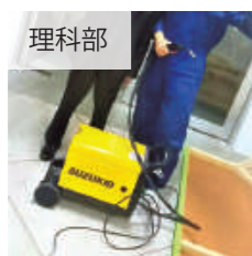
理科部 半自動溶接機
